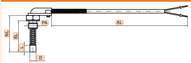
5: Kabelfühler gewinkelt, lose Verschraubung mit Druckfeder
