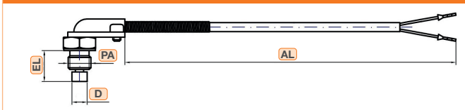
3: Kabelfühler gewinkelt, lose Verschraubung mit Druckfeder
